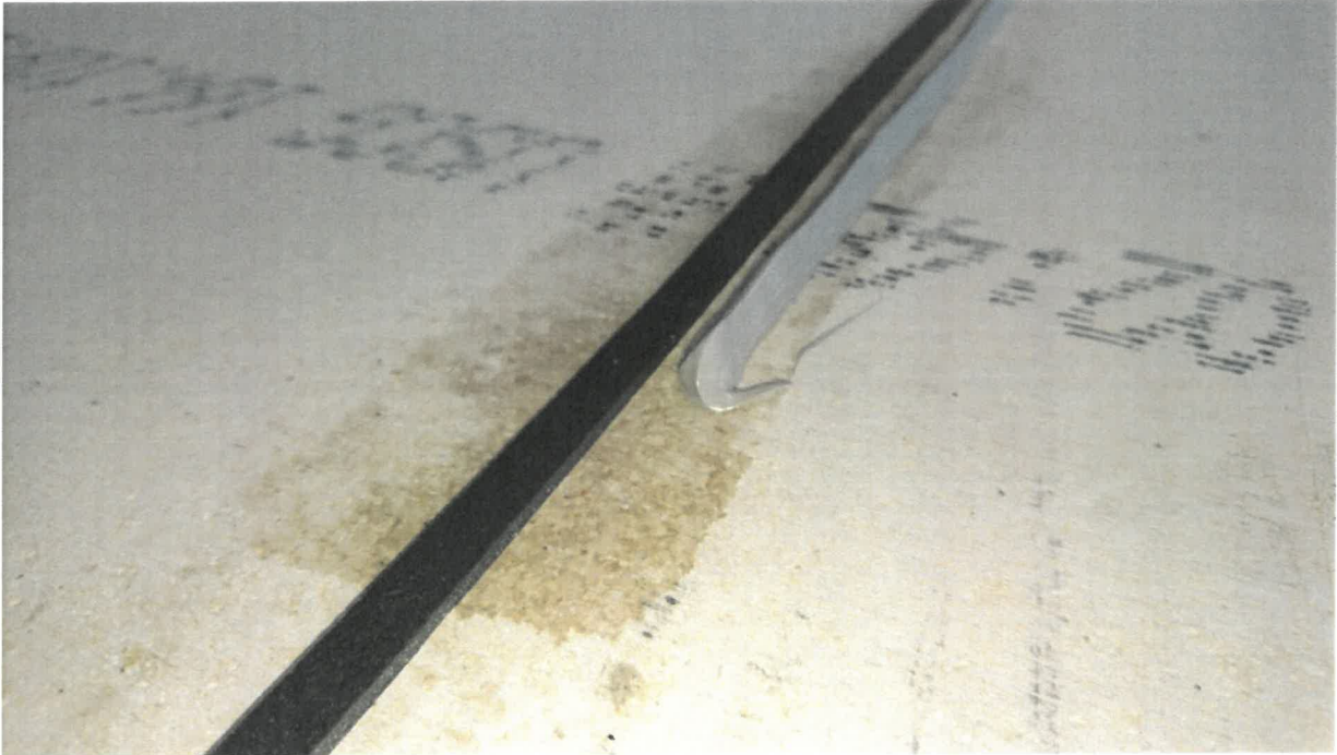
Bild 3: Herstellung des Panels. Aufbringen des Klebers (Detail)
